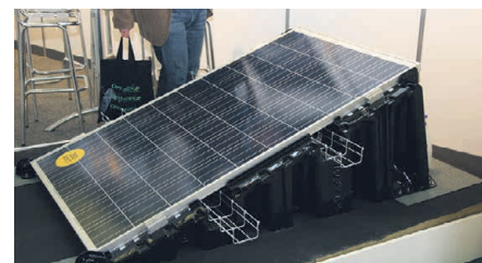
Modifitseeritud bitümenrullmaterjali (MBR) peale MBR lappidega paigaldatav päikesepaneeli alus. Sellise lahenduse kasutamine eeldab katuse kinnituse arvutusi.
