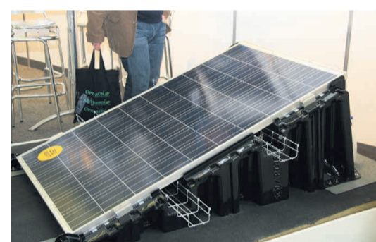
Modifitseeritud bituumenrullmaterjali (MBR) peale MBR lappidega paigaldatav päikesepaneeli alus. Sellise lahenduse kasutamine eeldab katuse kinnituse arvutusi.
