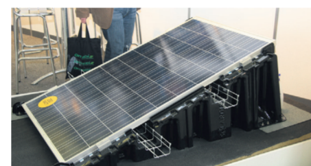
Modifitseeritud bituumenrollmaterjali (MBR) peale MBR lappidega paigaldatav päikesepaneeli alus. Sellise lahenduse kasutamine eeldab katuse kinnituse arvutusi.
